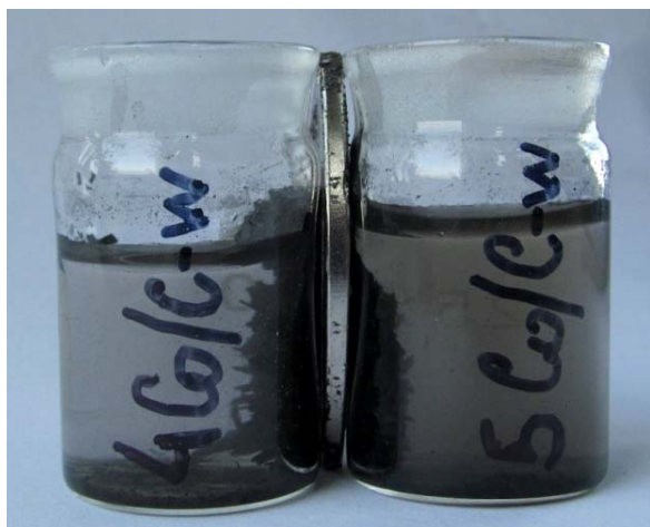
Рис. 5. Фотопроявления магнитной чувствительности образцов кобальт-углеродных нанокompозитов в воде. Названия образцов указаны на бюксах.
