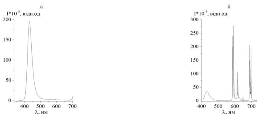
Рис. 6. Спектри люмінесценції у видимому – «синьому» (а) й «помаранчево-червоному» (б) – діапазонах спектру нерозчинного залишку системи \text{EuF}_3\text{-NaCl-KCl} : а) \lambda_{3б.} = 352 нм, щілина 0,6-0,6 нм, б) \lambda_{3б.} = 395 нм, щілина 0,6-0,6 нм
