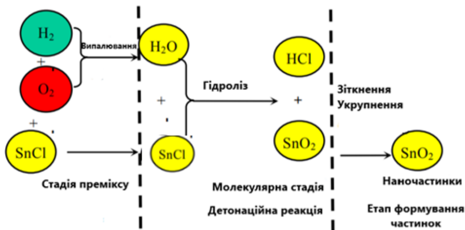
Рис. 13. Механізм детонаційного синтезу
