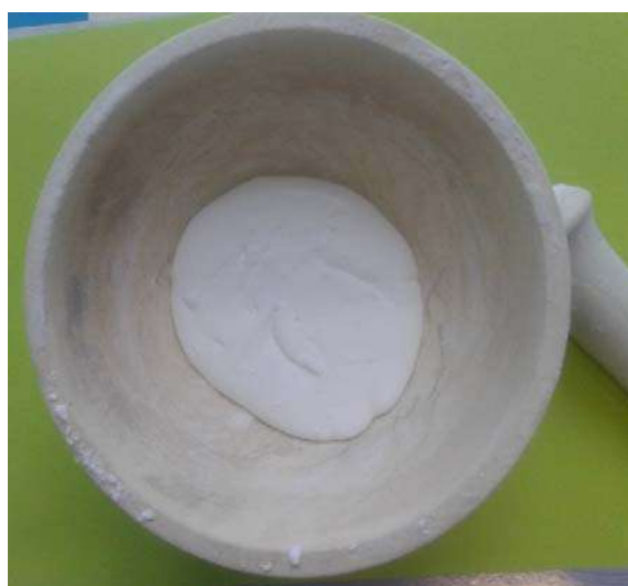
Рис. 24. Зміна фазового стану композиту 2/1 А-300/АМ-1, що містить 3 г/г \text{H}_2\text{O} : вихідного (а) і після легкого перетирання в порцеляновій ступці (б)
