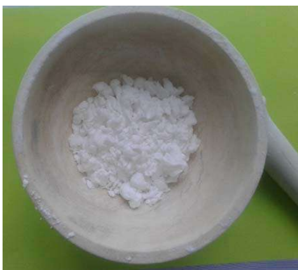
Рис. 24. Зміна фазового стану композиту 2/1 А-300/АМ-1, що містить 3 г/г \text{H}_2\text{O} : вихідного (а) і після легкого перетирання в порцеляновій ступці (б)
