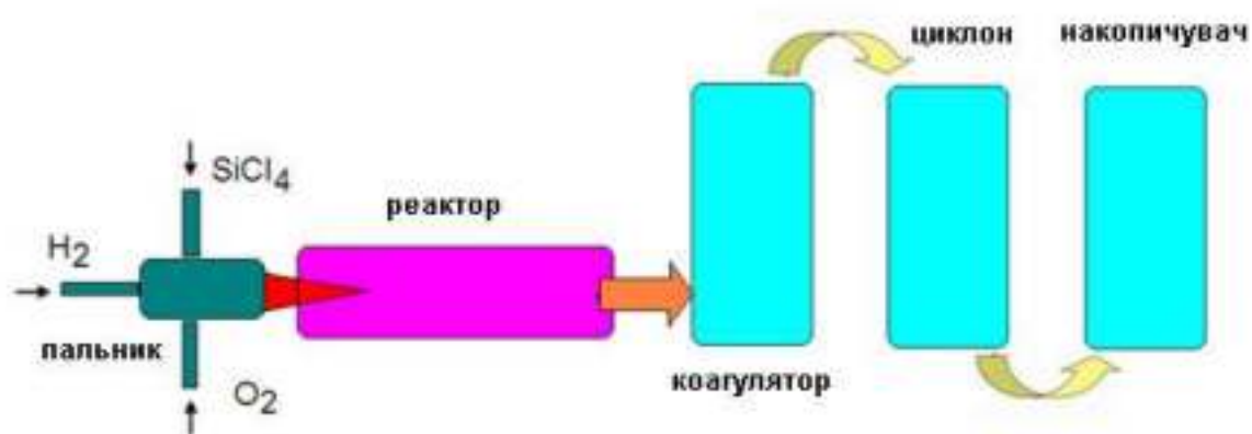
Рис. 1. Схема установки для проведення пірогенного синтезу дисперсного кремнезему
