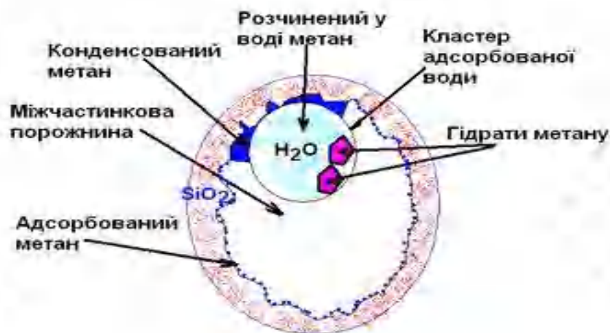
Рис. 8. Схема адсорбційних процесів в міжчастинкових зазорах гідратованого метилкремнезему в середовищі газоподібного метану
