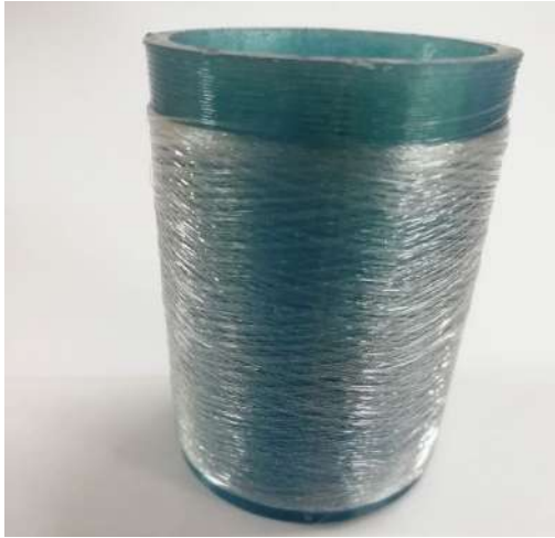
Рис. 1. Бобіни з мононитками з фільтерним витягуванням 500 % та кратністю витягування 4: a – ПП; б – ПП+5,0 мас. % Fe/C
