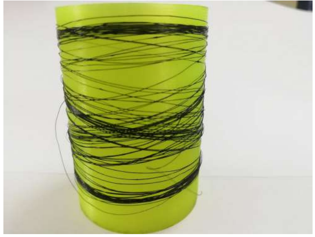
Рис. 1. Бобіни з мононитками з фільтерним витягуванням 500 % та кратністю витягування 4: a – ПП; б – ПП+5,0 мас. % Fe/C
