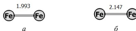
Рис. 2. Рівноважна структура димера заліза з найнижчою повною енергією, одержана методами V3LYP/6-31G(d,p) (а) та (б) MP2/6-31G(d,p) (тут і далі міжатомні відстані в Å).
