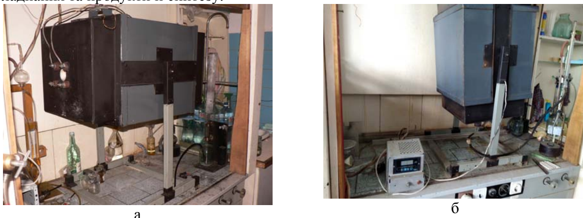
Рис. 2 На рисунках зображена піролітична установка з реактором в двох положеннях: горизонтальному (а) и вертикальному (б) [101]
