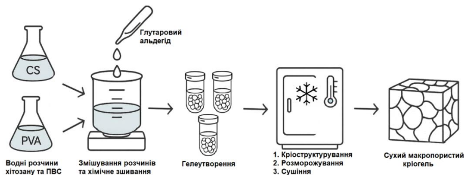
Рис. 3. Узагальнена схема кріоструктурування на прикладі водних розчинів хітозану та ПВС, хімічно зшитих глутаровим альдегідом (ГА)
