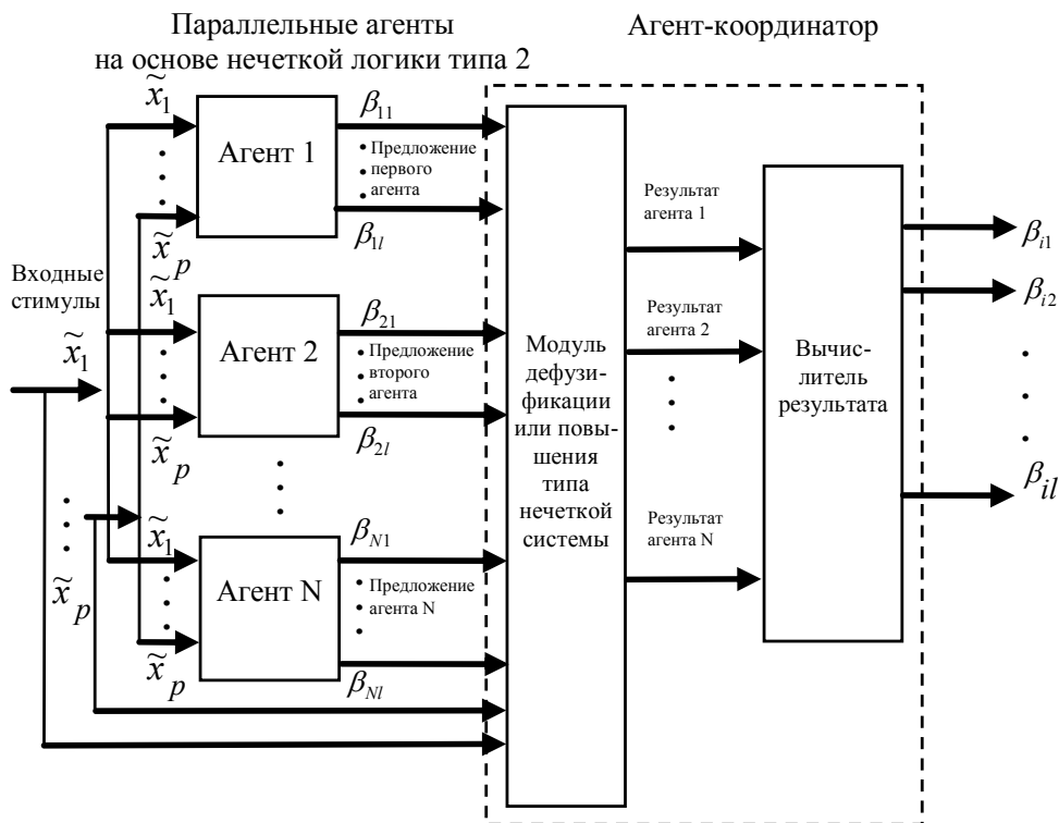
Рис. 2. Структура иерархической нечеткой мультиагентной системы для высокопроизводительной среды
