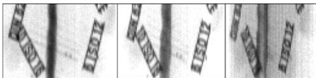
Рис. 5. Тіньові рентгенівські зображення зварного з'єднання, отримані під різними кутами зору
