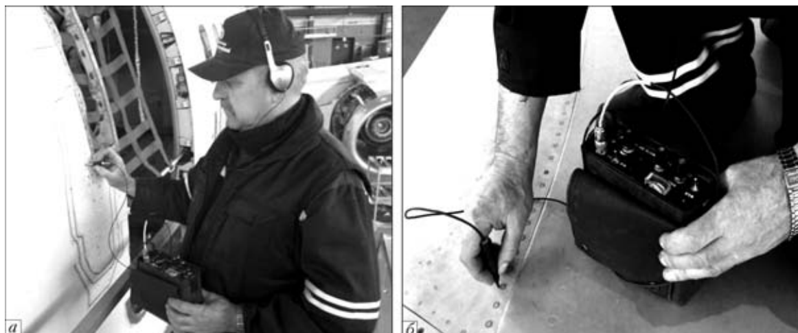
Рис. 2. Выявление дефектов на боковой стенке отверстий (а) и в зоне потайных заклепок на крыле самолета (б) с помощью дефектоскопа Леотест ВД 3.03
