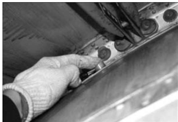
Рис. 5. Установка кольцевого ВТП на заклепку в зоне заднего гермошпангоута
