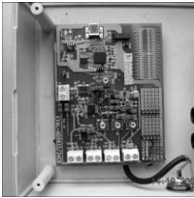
Рис. 4. Модуль обробки сигналу імпедансного датчика на базі AD5933
