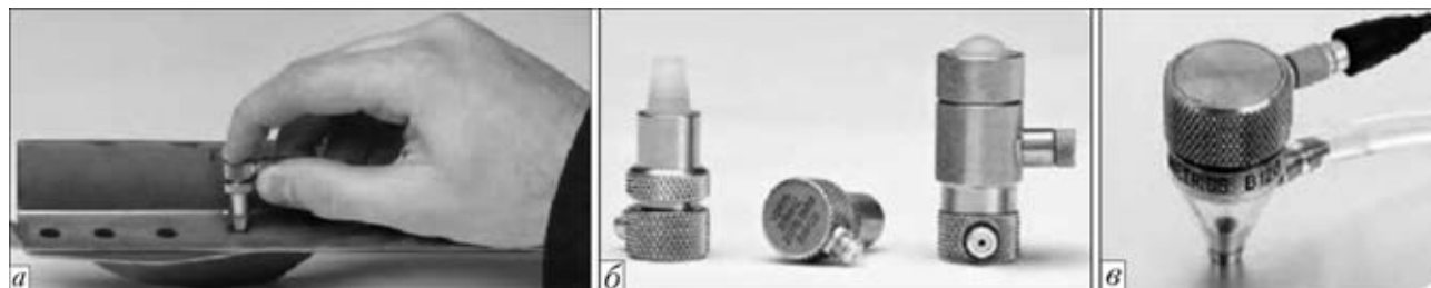
Рис. 7. УЗ преобразователи фирмы «Panametrics-NDT»: а — процесс контроля КТС; б — датчики серии V23xx и V24xx; в — фокусирующий датчик серии V316B (V312B)
