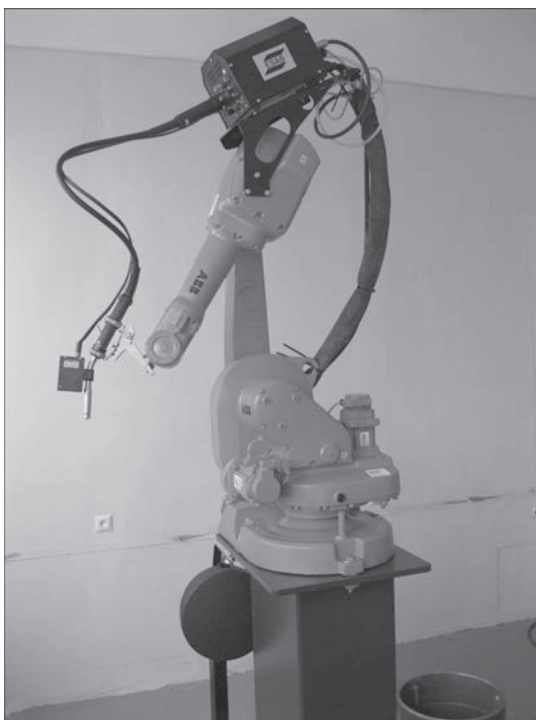
Рис. 6. Сварочный робот с лазерным датчиком, разработанным в ИЭС
