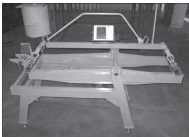
Рис. 1. Тележка путеизмерительная КВ-1П на испытательном стенде
