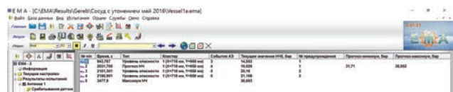
Рис. 14. Снимок части экрана программы EMA-3.91. Список выданных системой предупреждений 1, 2 и 3 уровней и прогноза разрушающей нагрузки для сосуда 24344
