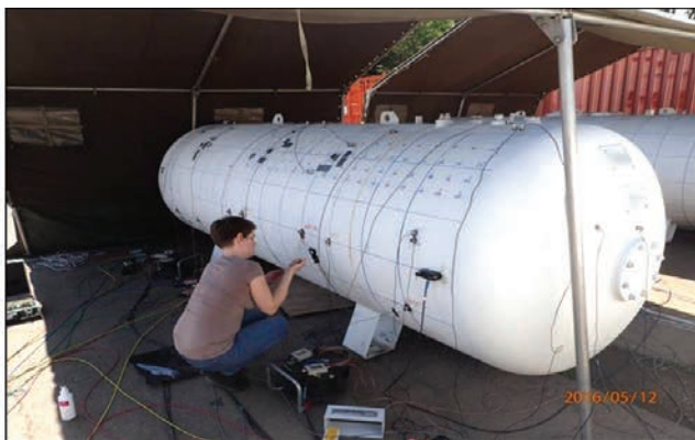
Рис. 3. Сосуд 24344. Подготовка к проведению гидроиспытания – установка датчиков АЭ
