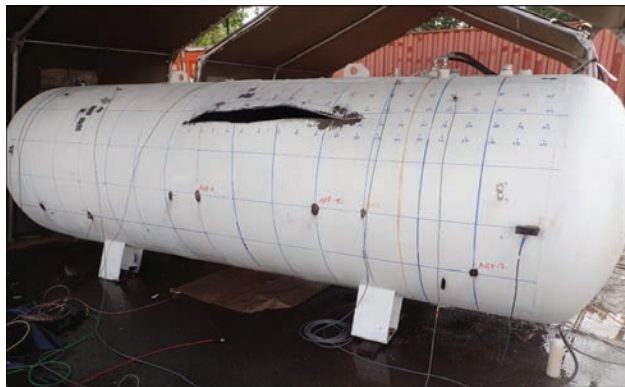
Рис. 17. Сосуд 24344 (с утонением) после разрушения
