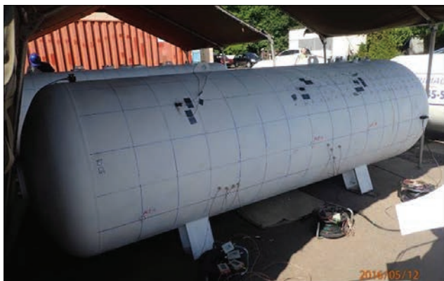
Рис. 3. Сосуд 24344. Подготовка к проведению гидроиспытания – установка датчиков АЭ
