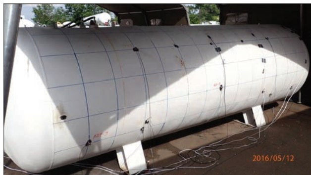
Рис. 4. Сосуд 24452. Подготовка к проведению гидроиспытания – установка датчиков АЭ
