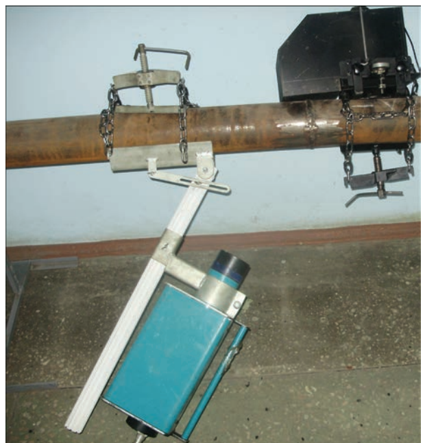
Рис. 6. Внешний вид переносной установки для неразрушающего контроля сварных швов
