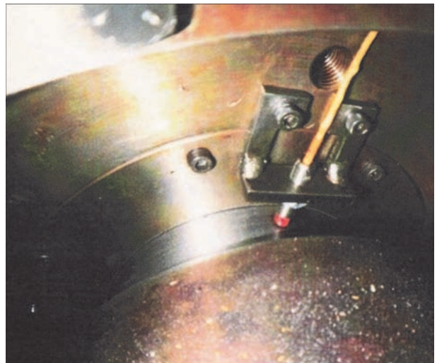
Рис. 1. Расположение индукционного датчика смещений ротора
