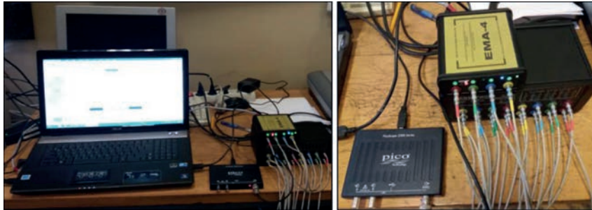
Рис. 5. Схема измерения коэффициента усиления и АЧХ
