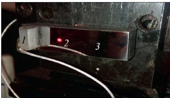
Рис. 5. Стальний зразок із призмий перетворювачем: 1 – призмий перетворювач; 2 – пляма зондуючого лазерного променя; 3 – зразок
