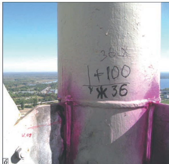
Рис. 14. Старая и новая вентиляционные трубы (а) четвертого реактора ЧАЭС. Капиллярный контроль элементов каркаса новой вентиляционной трубы Чернобыльской АЭС (б)
