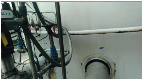
Рис. 2. Визначення місць для встановлення датчиків АЕ (вибірково)
