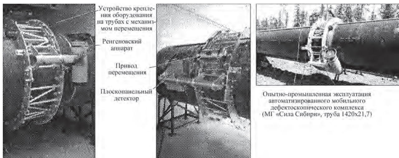
Рис. 4. Пример радиационного контроля качества кольцевых сварных соединений магистральных трубопроводов: масса комплекса – 80 кг; активная площадь плоскопанельного детектора – 200×200 мм; размер пикселя детектора – 200 мкм; скорость контроля сварного шва трубы 1420×25,8 мм – 40 мин; чувствительность контроля, класс по ГОСТ 7512 – 1 (журнал «Территория «Нефтегаз», 2016, № 10)
