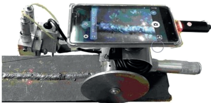
Рис. 1. Пристрій для візуального контролю ВВК/ТВА-1
