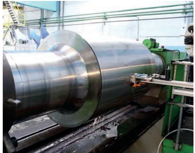
Установка автоматизованого ультразвукового і вихрострум-ового контролю прокатних валків РНК В-35 (L)
