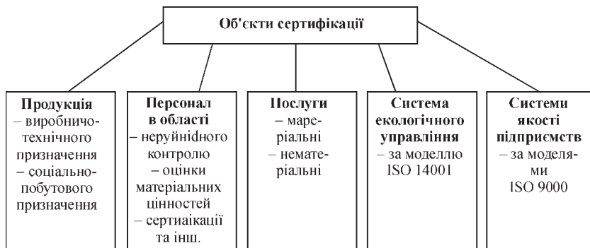
Рис. 2. Об'єкти сертифікації в зварювальному виробництві конструкцій [4]
