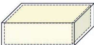
Рис. 1. Схема умовної заготовки з поліаміду ПА6 марки Б з виділеною штрихом зоною непрозорості матеріалу для видимого світла
