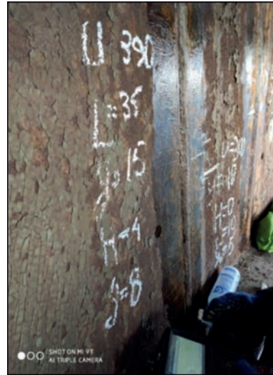
Рис. 3. Контроль стикових вертикальних швів з'єднувальної вставки
