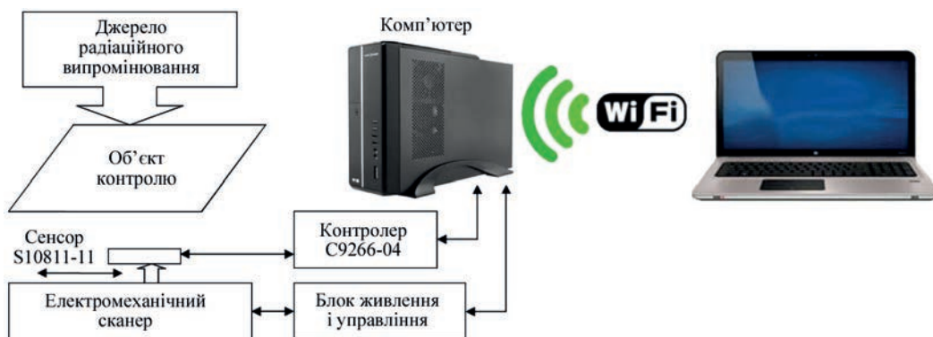
Рис. 12. Блок-схема цифрової рентгенотелевізійної системи
