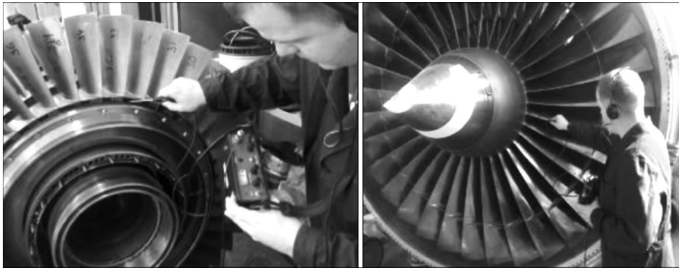
Рис. 9. Контроль деталей АД дефектоскопом ЛЕОТЕСТ ВД 3.03Н
