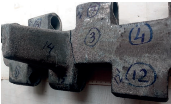
Рис. 7. Загальний вигляд втрати суцільності (утворення тріщини) металу траків 1–4 (2021) після випробувань на 4-х точковий згин
