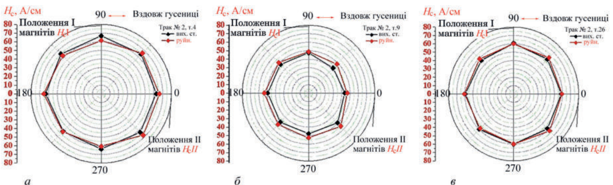
Рис. 6. Характерні епюри коерцитивної сили в різних точках поверхні експериментальних траків 1–4 (2021) у вихідному стані та після випробувань за схемою 1 (рис. 2, а): а – точка 4; б – точка 9; в – точка 26
