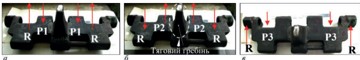
Рис. 2. Схеми навантаження траку при випробуваннях на 4-х точковий статичний згин [5]
