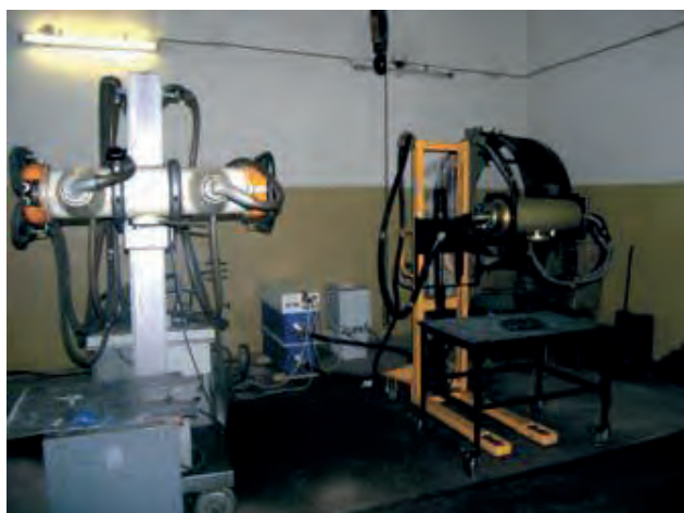
Стаціонарні рентгенівські апарати РУП 150/300 і «Екстрасоль-360» в рентгенівській лабораторії ІЕЗ ім. Є.О. Патона НАНУ
