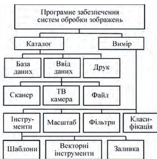
Система цифрової обробки рентгенограм: а – робоче місце оператора, б – зображення вихідної рентгенограми зварного з'єднання, в – зображення рентгенограми зварного з'єднання після цифрового контрастування, г – структура програмного забезпечення
