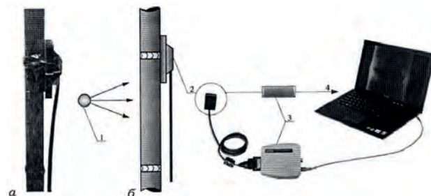
Рентгенотелевізійний контроль стикових з'єднань арматури ( а ) і труб малого діаметра ( б ): 1 – джерело випромінювання; 2 – мініатюрний твердотільний перетворювач; 3 – блок передачі цифрових зображень; 4 – виведення
