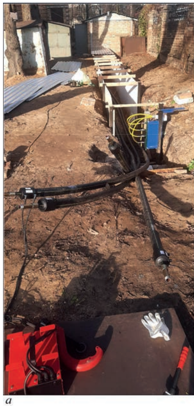
Рис. 1. Науково-дослідний стенд для вивчення впливу водню та його газових сумішей з метаном на матеріал поліетиленових труб: загальний вигляд науково-дослідного стенду (а); процес терморезисторного зварювання стенду (б)
