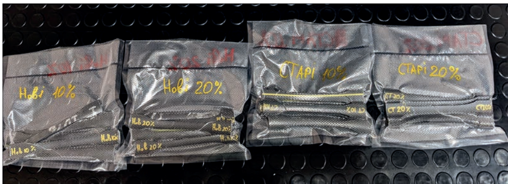
Рис. 4. Вакуумовані зразки поліетиленових труб для структурних досліджень
