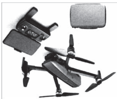
Рис. 2. Дрон MJX D16 Pro, оснащений великим набором датчиків, відеокамерою, бортовим комп'ютером та ін.
