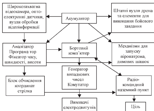
Рис. 3. Блок-схема взаємодії вузлів дрона
