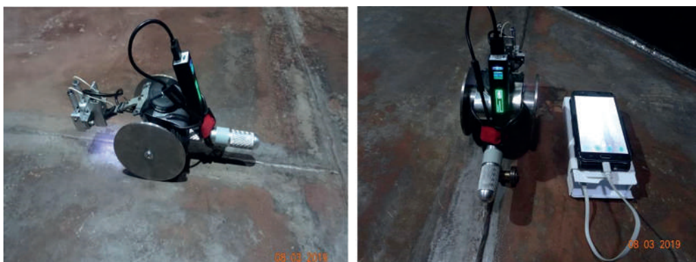
Рис. 5. Випробування пристрою запису візуальної інформації ВИК/ТВА-1 на зварних з'єднаннях днища резервуара РВС-200
