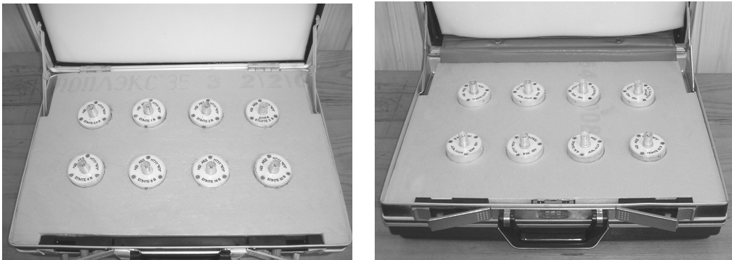
Рис. 14. Зовнішній вигляд комплекту еталонних (ліворуч) і переносних (праворуч) перетворювачів напруги термоелектричних, розробленого в НІІ АЕІ НТУУ “КПІ”.
