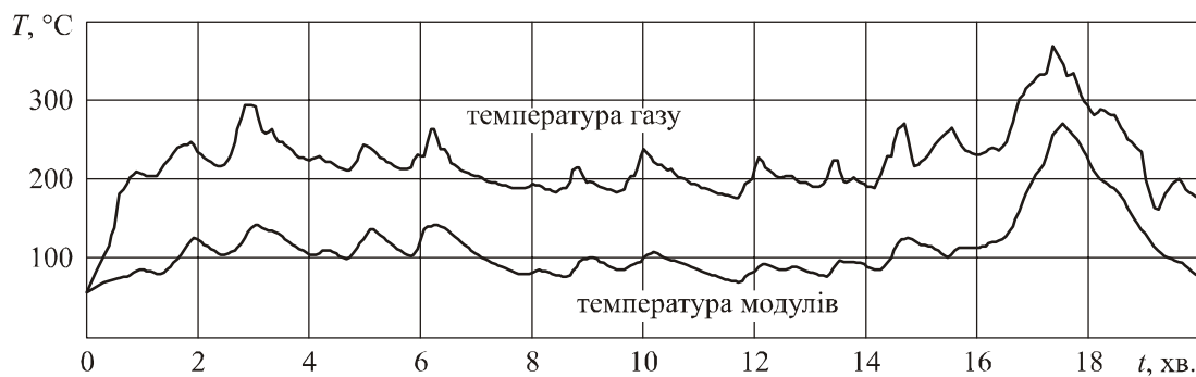
Рис. 6. Температура вихлопного газу й розрахована за методикою [13] температура модулів.
