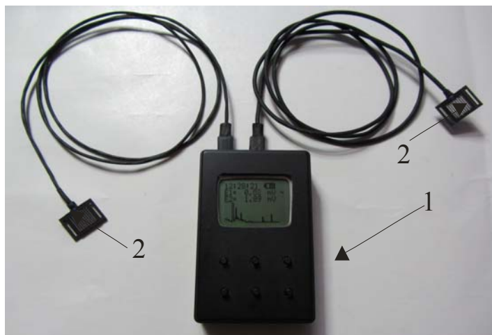
Рис. 1. Модернізований прилад для вимірювання теплових потоків людини: 1 – електронний реєстратор, 2 – термоелектричний сенсор теплового потоку і температури.
