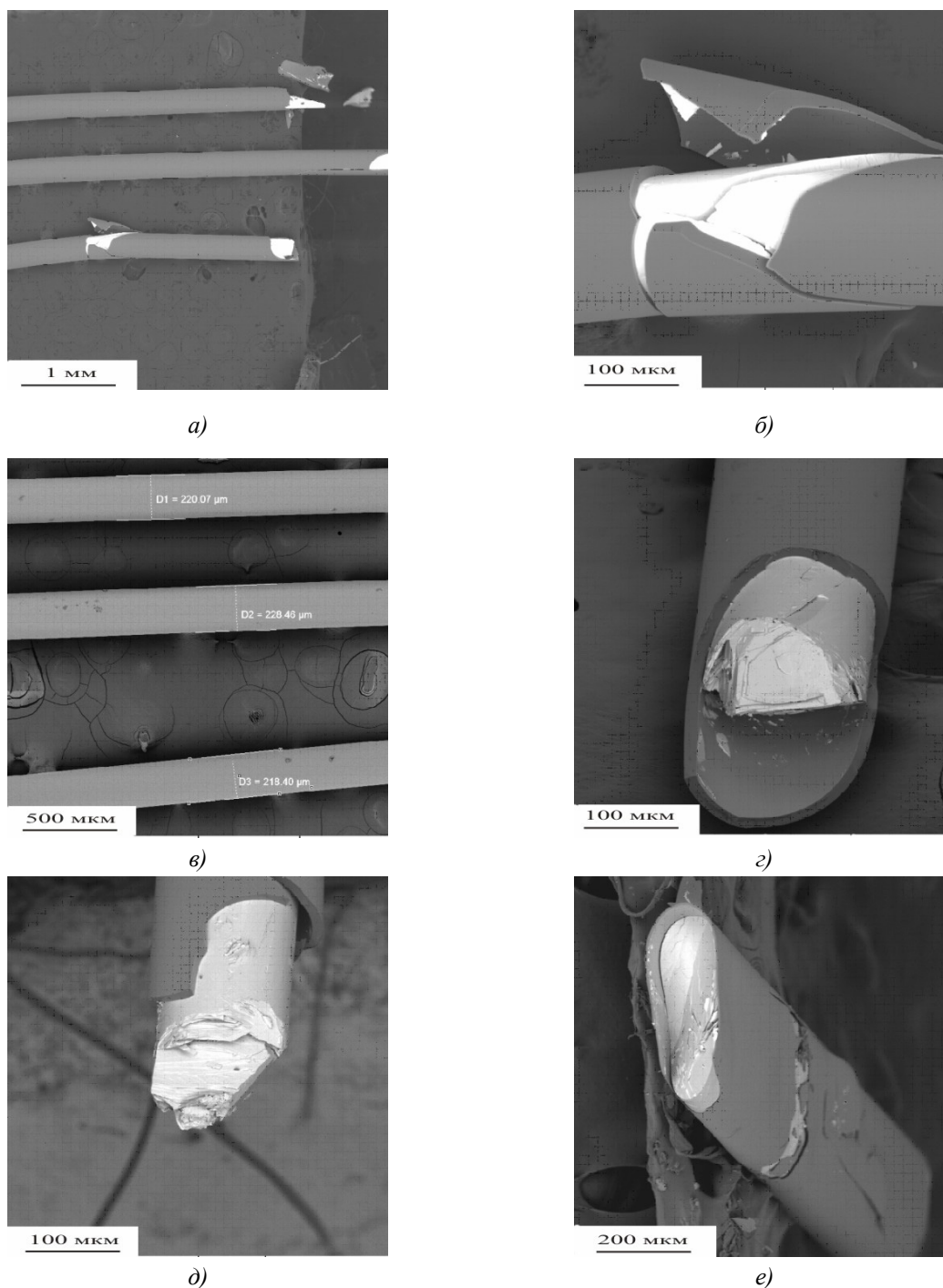
Рис. 3. Провідники (а,в) і злами (б,г,д,е) Bi_{0.5}Sb_{1.5}Te_3 у скляній оболонці: молибденове скло (а,б), пірекс(в,г,д,е). Швидкості витяжки 0.1 м/с (а,б,в,г,д), 0.03 м/с (е)
