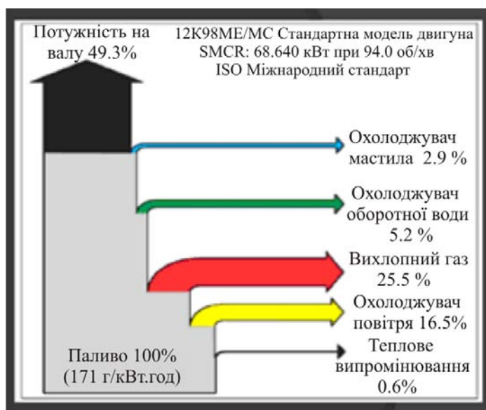
Рис.2. Розподіл потоків енергії в судновому дизельному двигуні, [7].
