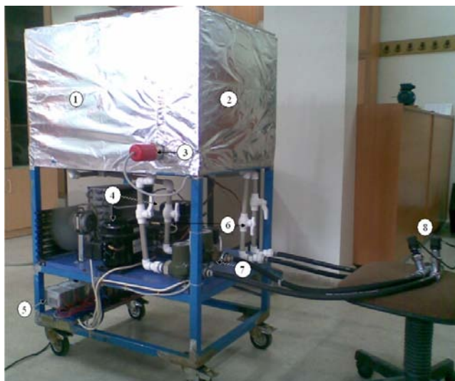
Рис. 3. Система рециркуляції гарячої й холодної води.
