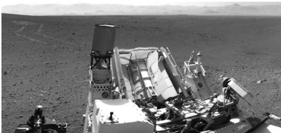
Рис. 2. Багатоцільовий РІТЕГ на Марсі. Цей знімок зроблений на 24 марсіанську добу.
