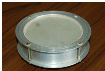
Рис.2. Зовнішній вигляд системи для охолодження елементів РЕА, що працюють в режимі повторно-короткочасних тепловиділень.
