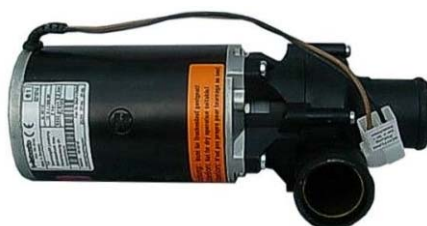
Рис. 2. Зовнішній вигляд циркуляційної помпи рідинного передпускового нагрівника «LGW 300» (Webasto) [9].
