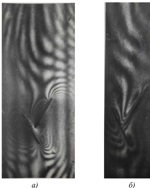
Рис. 9. Зображення подряпин, нанесених під кутом до вектора дифракції g_{220}^- : а) при кімнатній температурі; б) після відпалу 1023 К, \times 10 .
