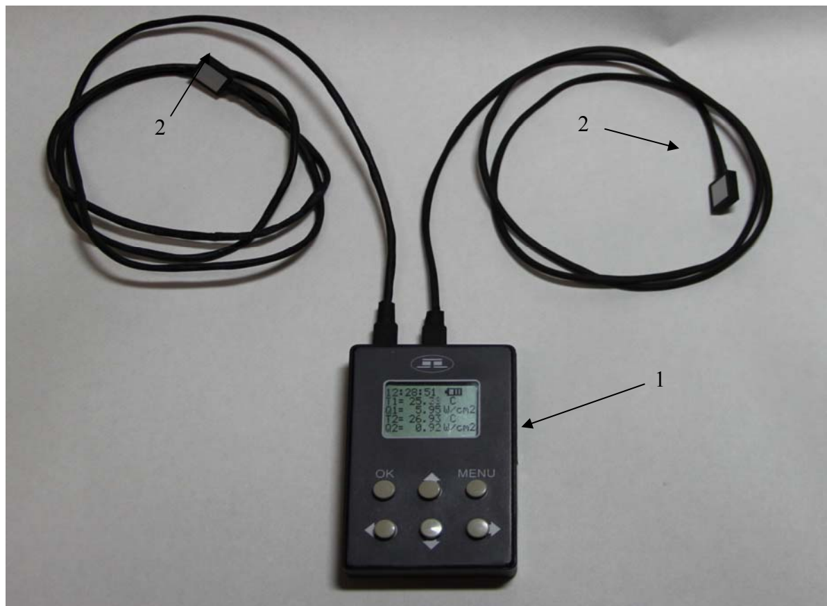
Рис. 1. Термоелектричний прилад для вимірювання температури і теплових потоків: 1 – блок керування, 2 – термоелектричний сенсор температури і теплового потоку.
