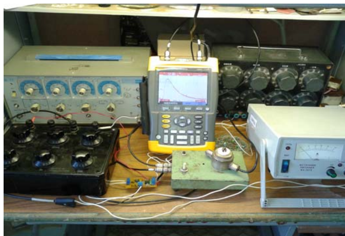
Рис. 2. фото стенду для вимірювання параметрів ІТП
