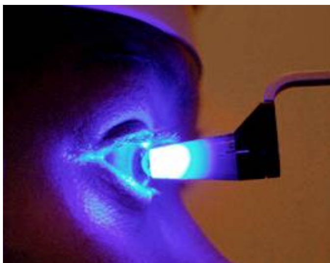
Рис. 7. Положення контактної призми, закріпленої в штативі тонометра Гольдмана, в процесі дослідження за допомогою термоелектричного сенсора теплового потоку
