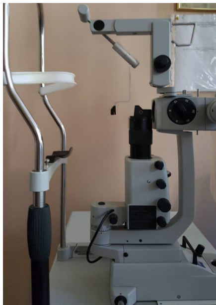
Рис. 5. Штатив тонометра Гольдмана, закріплений на біомікроскопі
