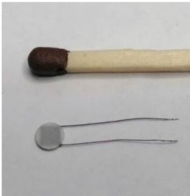
Рис. 3. Термоелектричний сенсор теплового потоку діаметром 3 мм і висотою 0.7 мм
